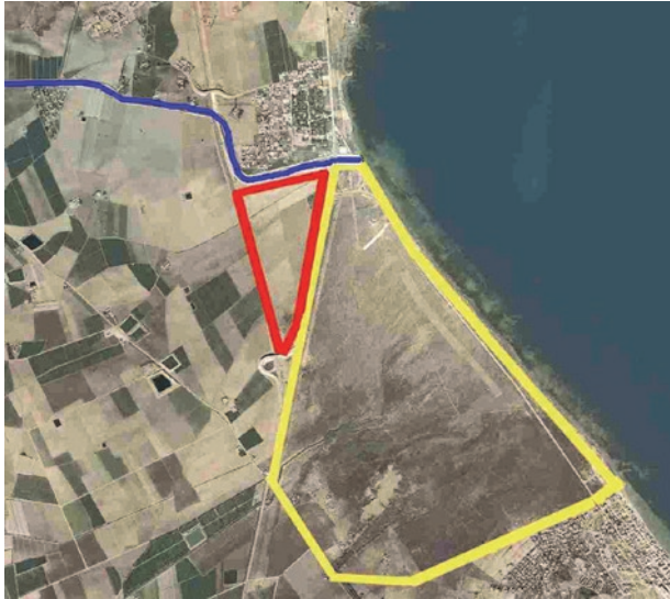
Figura 3.29. Zona de posible recuperación para el humedal de Marina del Carmolí. Marina del Carmolí (perímetro en amarillo) y área adyacente (perímetro en rojo) en la que podría recuperarse parte de la superficie de humedal que fue transformada a usos agrarios, con el fin de actuar como filtro verde de los flujos procedentes de la cuenca, en particular de la Rambla del Albujón (en azul), actualmente desconectada del humedal.
